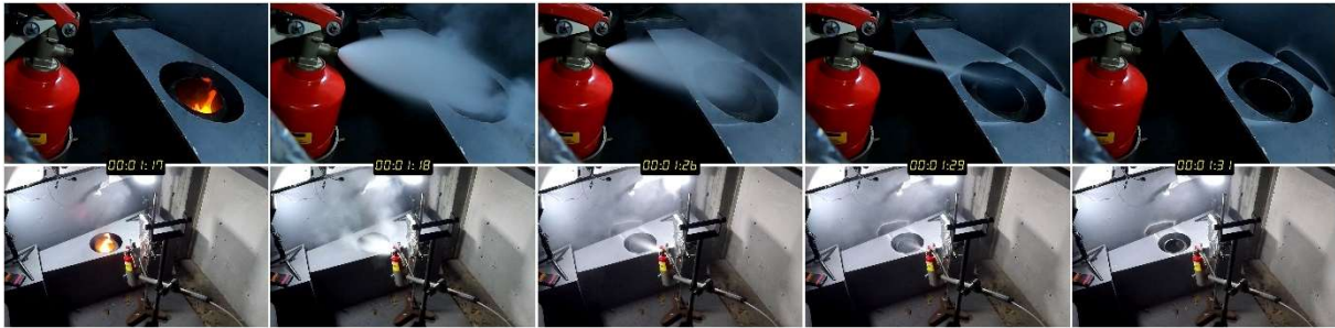
Figure 49 : essai Extincteur_01 – Séquence vidéo (Source : BEA)
