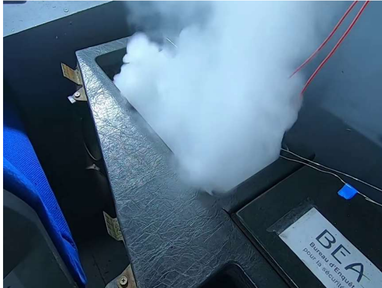
Figure 27 : dégagement de fumées constaté lors de l'essai Batterie_Lithium_05
