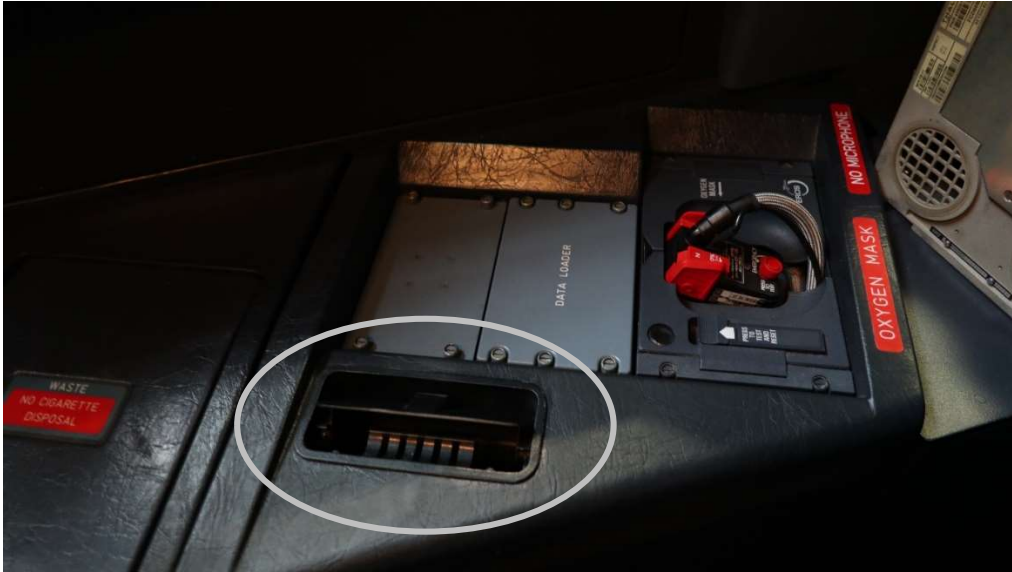
Figure 5 : exemple de cendrier dans un cockpit d'Airbus A330 (Source : BEA)
