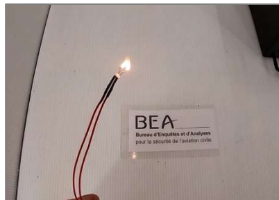
Figure 35 : dispositif de production d'étincelle (Source BEA)
