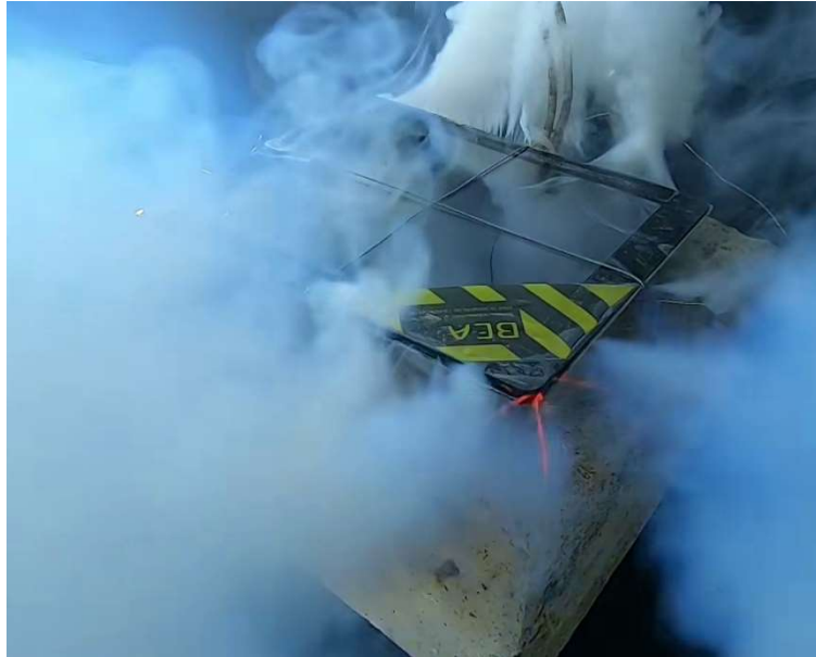
Figure 24 : exemple de libération de fumée lors de l’emballement thermique d’une batterie (essai Batterie_Lithium_04)
