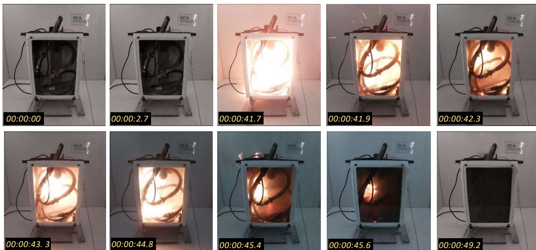
Figure 38 : endommagement interne du flexible d'oxygène du masque (Source BEA)
