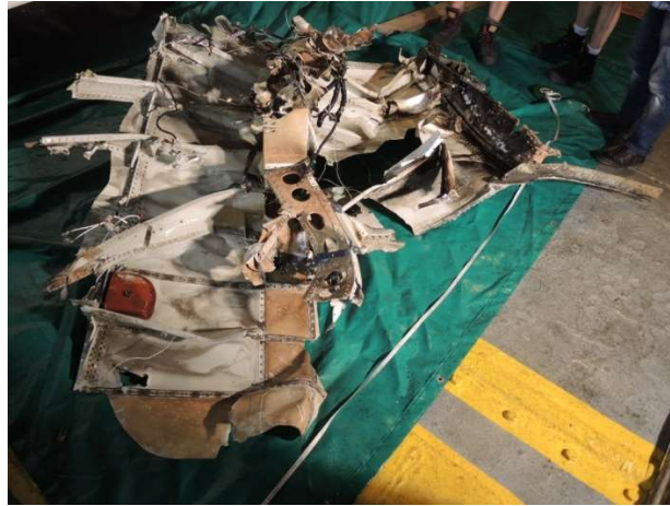
Figure 16 : débris du cockpit portant des dépôts noirs (Source BEA/EEAID)
