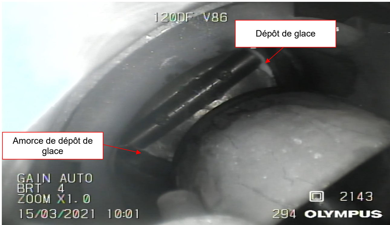
Figure 104 : Progression du phénomène de givrage => instant désigné t_0+2\text{min} Source : BEA
