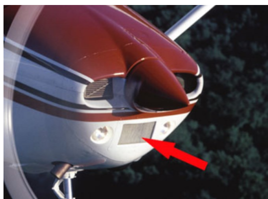
Figure 3 : Zone favorisant le givrage d'impact Source : aopa.com
