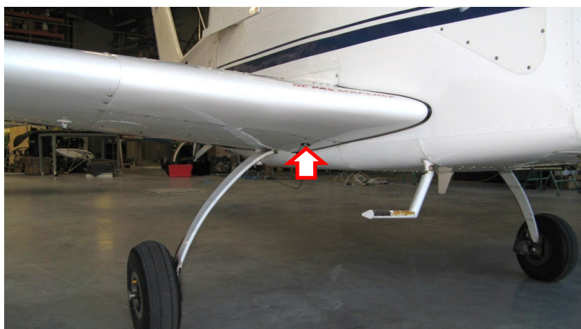
Figure 197 : Capteur de mesures de température et d'humidité relative Source : BEA
