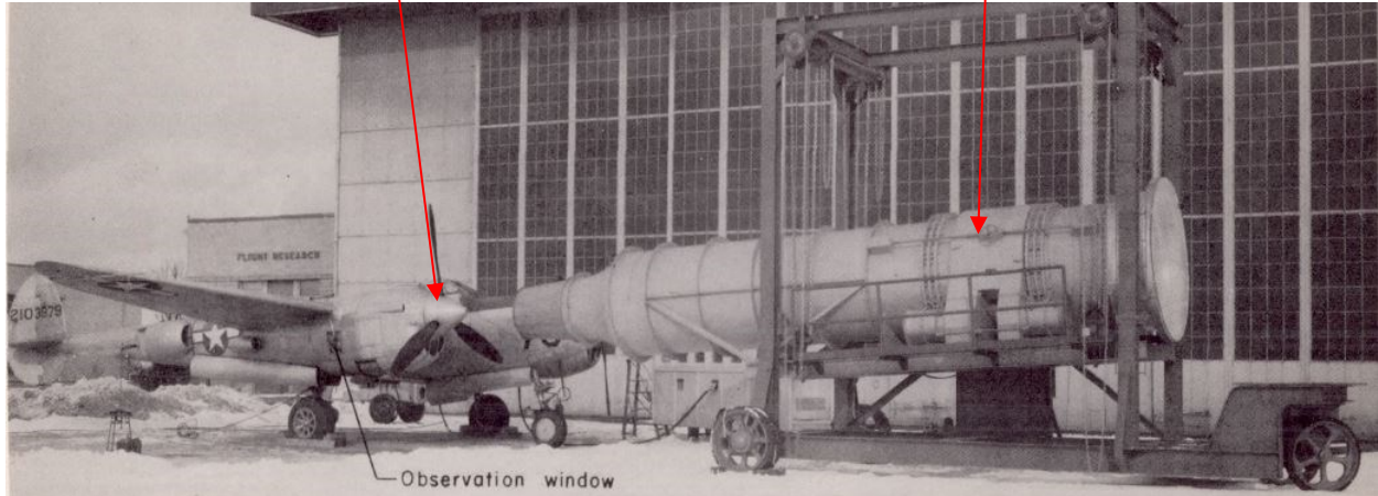
Figure 23 : Illustration d'un montage d'essais sur une installation motrice complète Source : Investigation of ice formation in the induction system of an aircraft engine _ I-Ground tests _ Henry A. Essex, Edward D. Zlotowski and Carl Ellisman _ Mars 1946
