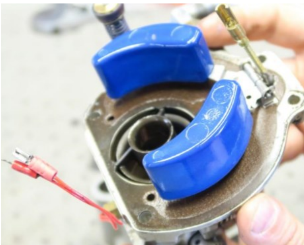
Figure 11 : Illustration des deux flotteurs associés par une pièce métallique
