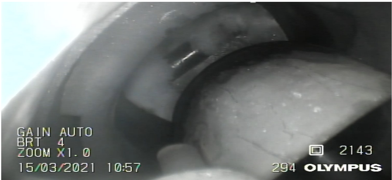
Figure 114 : Progression du phénomène de givrage => amorce de la phase 5 => instant désigné t_4 Source : BEA
