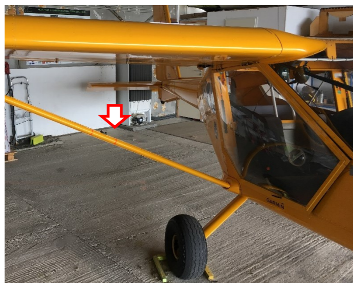
Figure 186 : Capteur température/humidité relative Source : BEA
