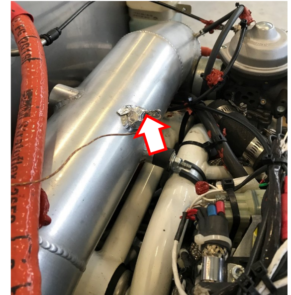
Figure 214 : Capteur de mesure de température Source : BEA
