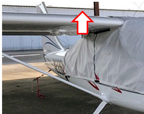
Figure 215 : Position du capteur de mesures de température et d'humidité relative Source : BEA
