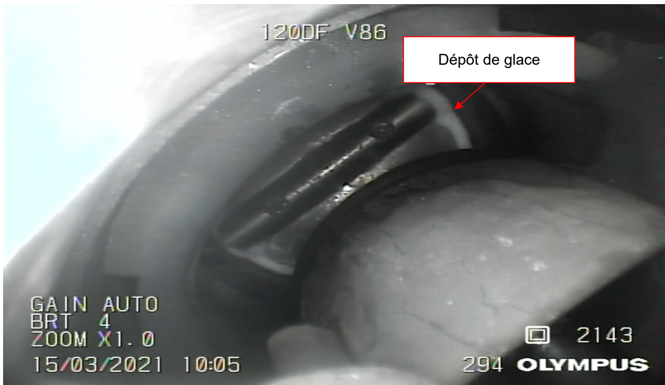
Figure 106 : Progression du phénomène de givrage => instant désigné t_0 + 5 \text{ min } 43 \text{ s} Source : BEA
