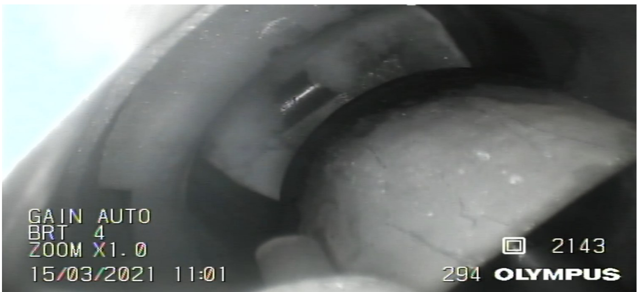
Figure 115 : Progression du phénomène de givrage => instant désigné t_{4+4\text{min}} Source : BEA
