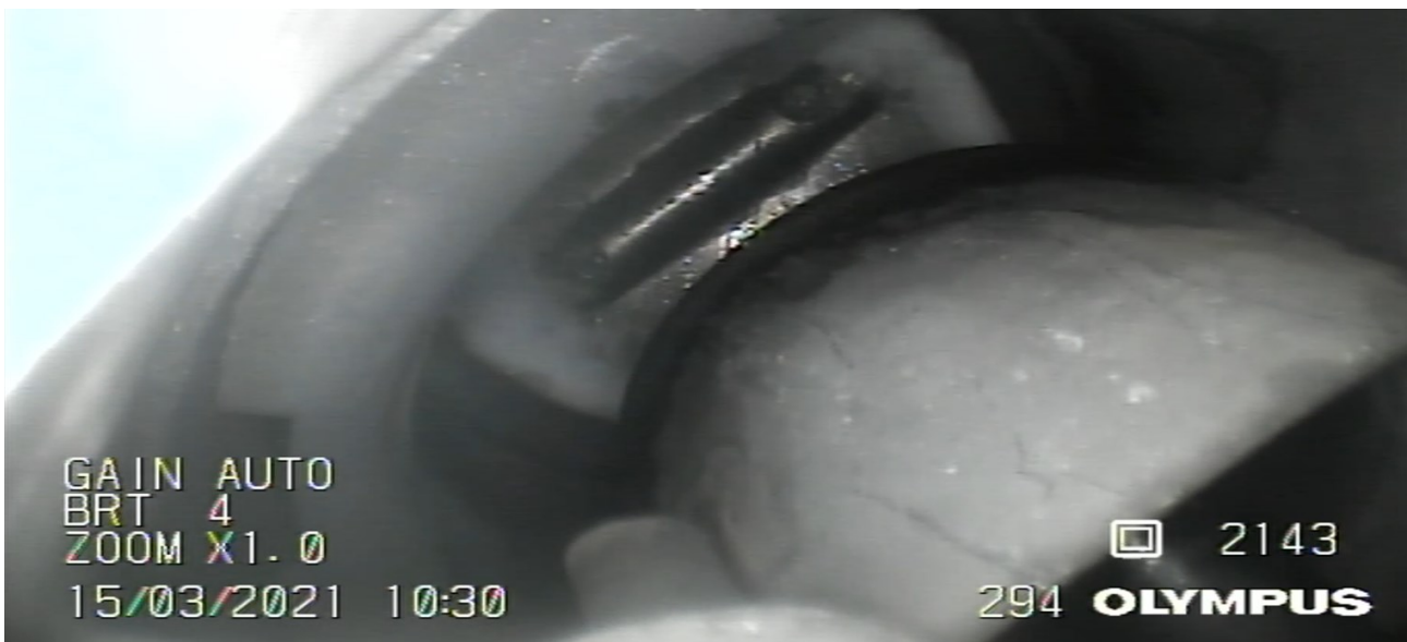
Figure 109 : Progression du phénomène de givrage => instant désigné t_{1+11\text{min}40\text{s}} Source : BEA
