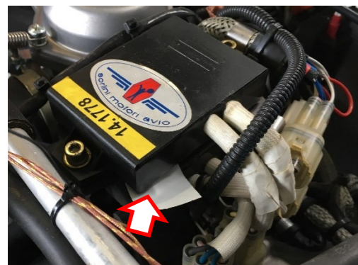
Figure 178 : Capteur température Source : BEA
