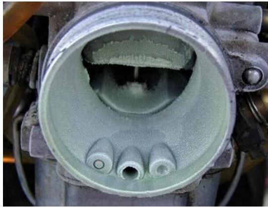
Figure 5 : Givrage d'un carburateur à dépression constante
