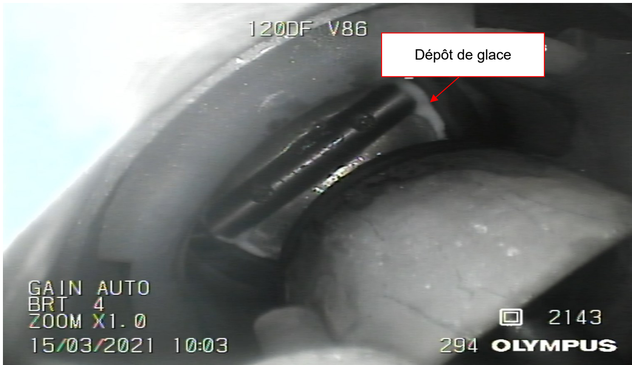
Figure 105 : Progression du phénomène de givrage => instant désigné t_{0+4min} Source : BEA
