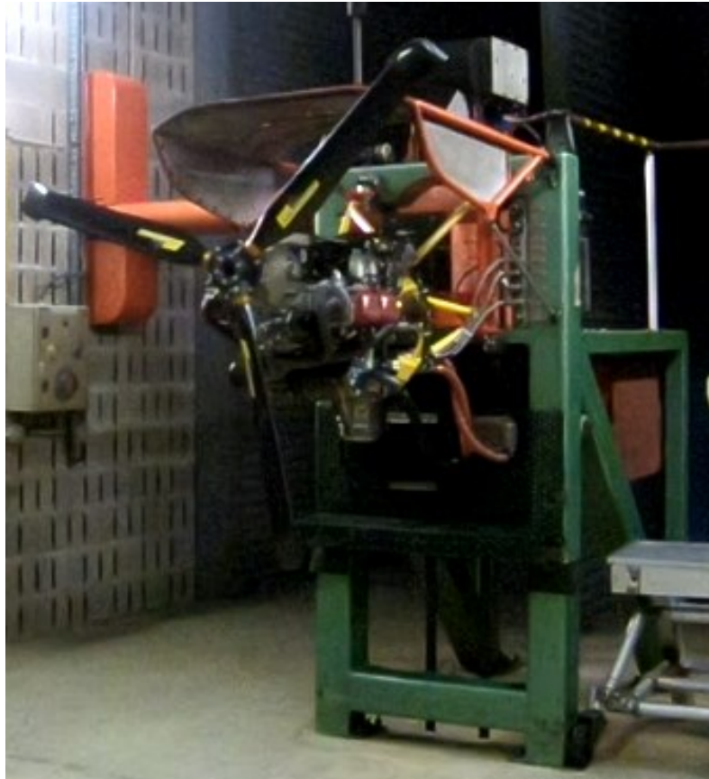
Figure 150 :Moteur Rotax 914 du BEA installé au banc d'essais de l'ENAC Castenaudary Source : BEA
