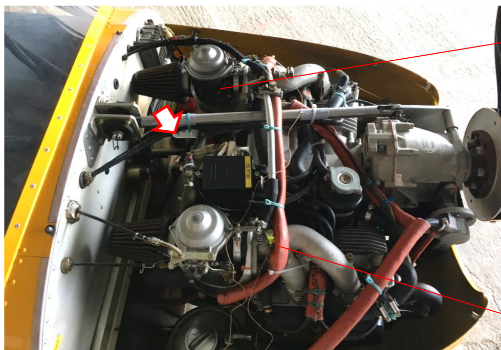
Figure 187 : Capteur température/humidité relative Source : BEA
