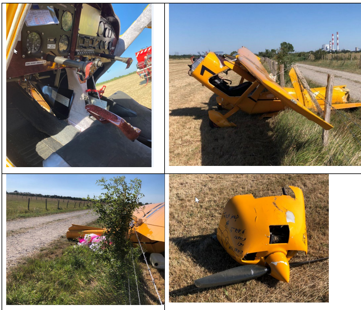
Figure 1 : épave de l'ULM : volants rompus, cellule avec parachute, bâti-moteur désolidarisé
