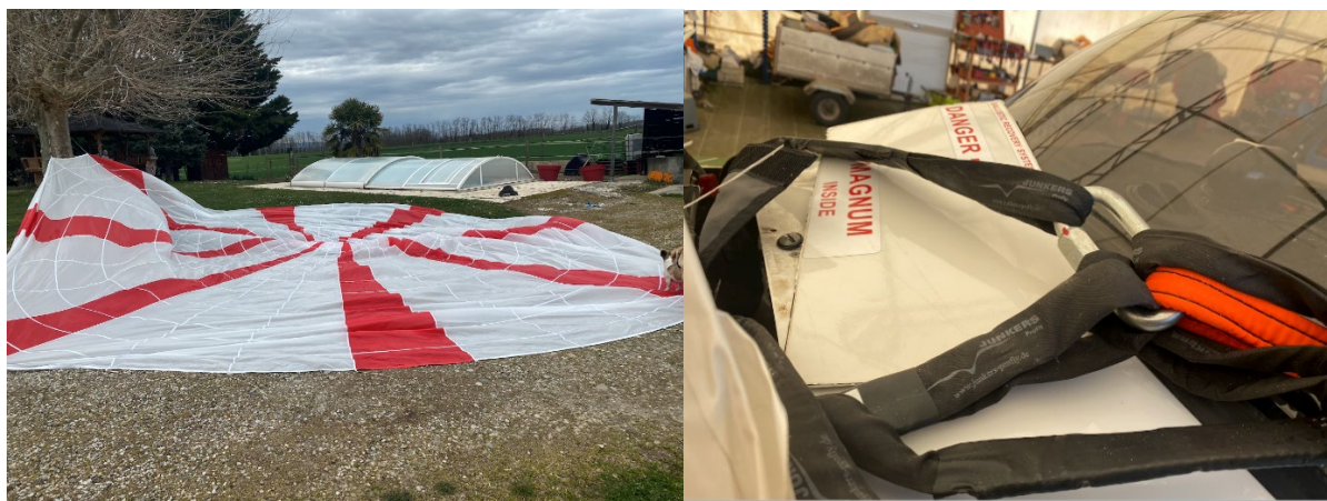
Figure 5 : parachute de secours (à gauche : toile du parachute, à droite : interfaces, sangles)
