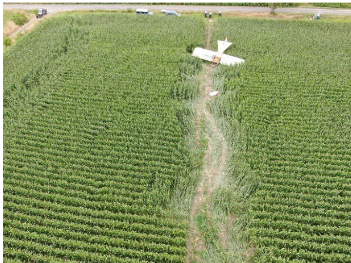
Figure 8 : ULM traîné dans le champ par le parachute
