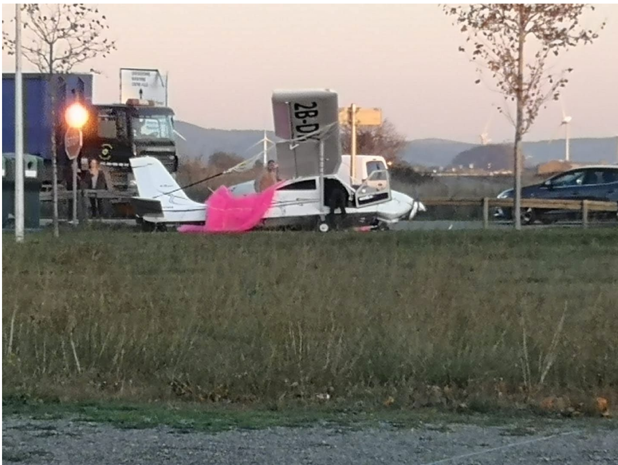
Figure 17 : 2BDK après activation du parachute (Source : Raynald Cornart, L'indépendant )
