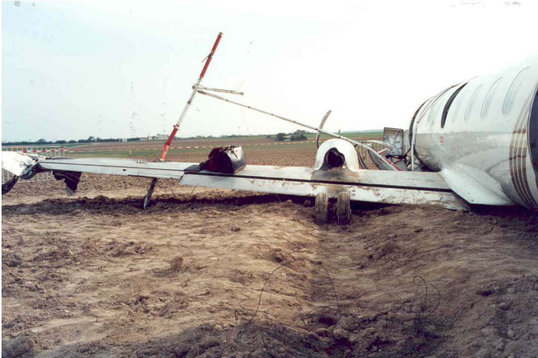
Aile gauche : traces creusées par le train affaissé
