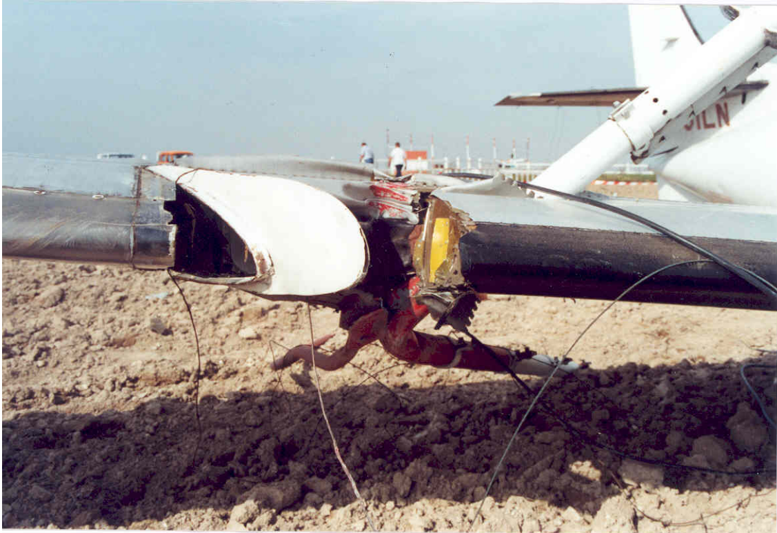
Aile droite : poteaux d'antenne LOC enfoncés jusqu'au longeron
