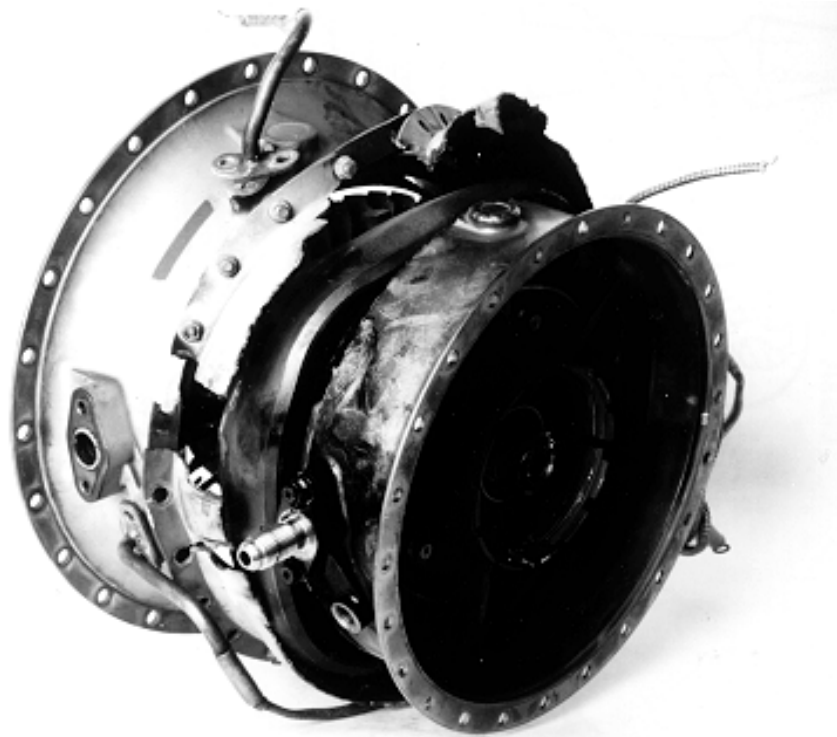
Ensemble carter turbines N1 et N2
