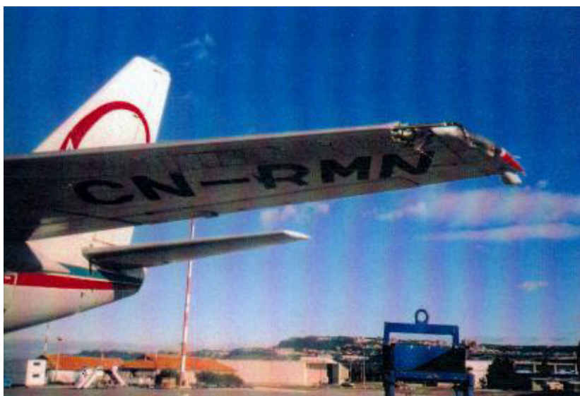
Extrémité endommagée du bec, aile gauche
