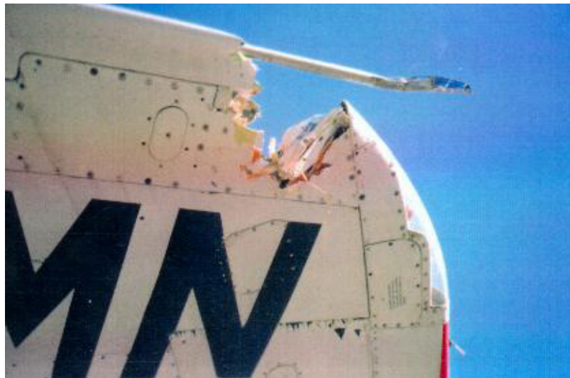
Conduit d'alimentation du système antigivrage, aile gauche
