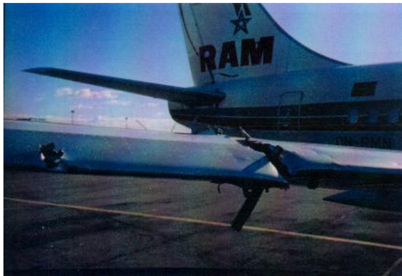
Bec mobile de bord d'attaque sectionné Conduit d'alimentation du système antigivrage sectionné
