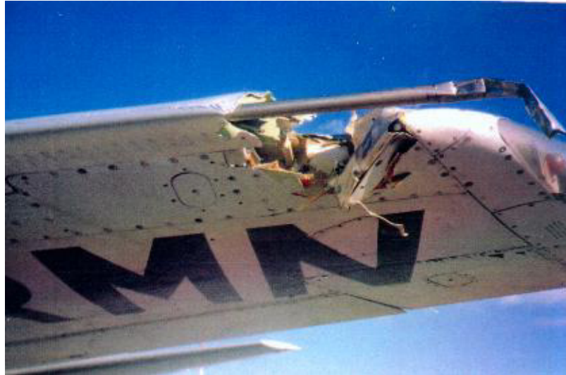
Revêtement et structure aile gauche écrasé jusqu'au niveau du longeron à hauteur du bec
