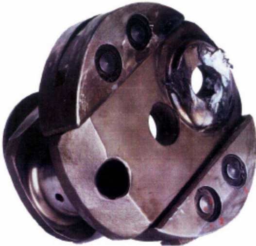
Vis-à-vis de la cassure près du bras M5/M6
