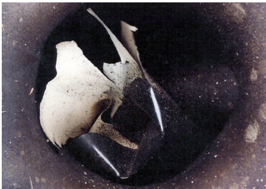
Photographie 5 : Détail du morceau de peinture obstruant le venturi du carburateur
