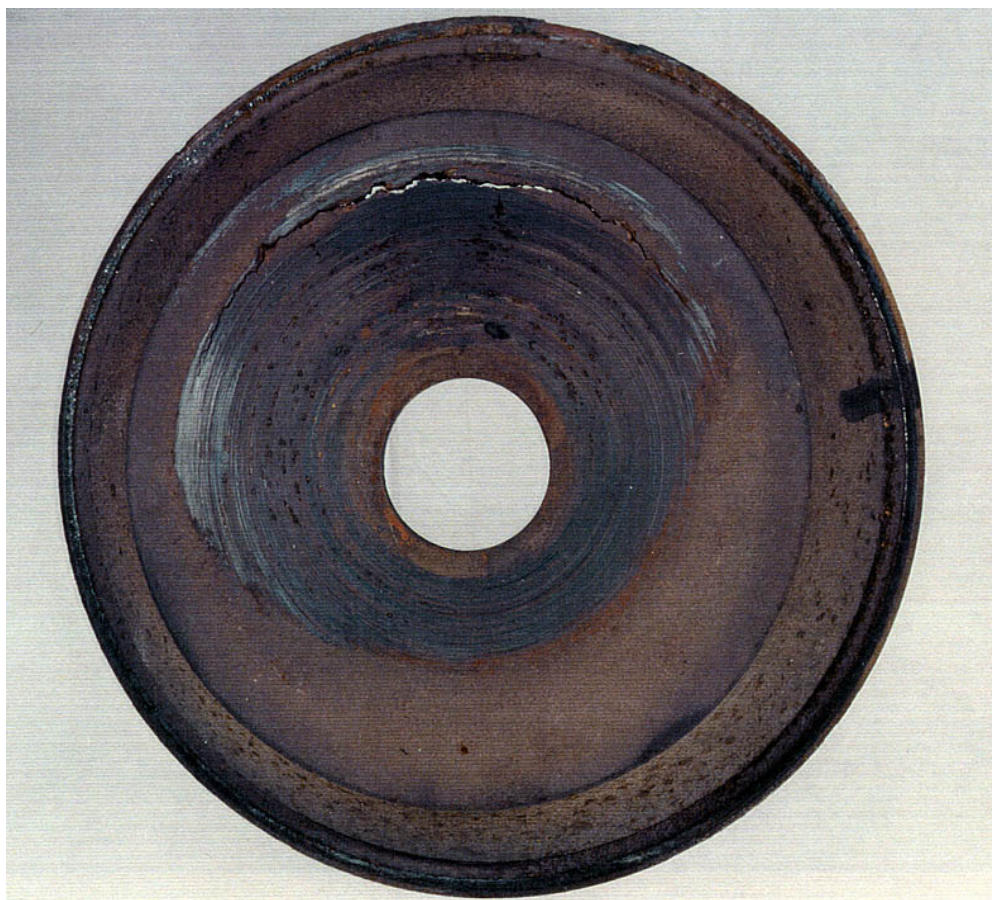
Arbre et face avant de la turbine
