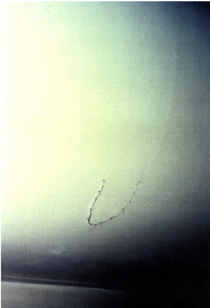
Perforation dans le fuselage occasionnée par l'arbre après sa rupture.
