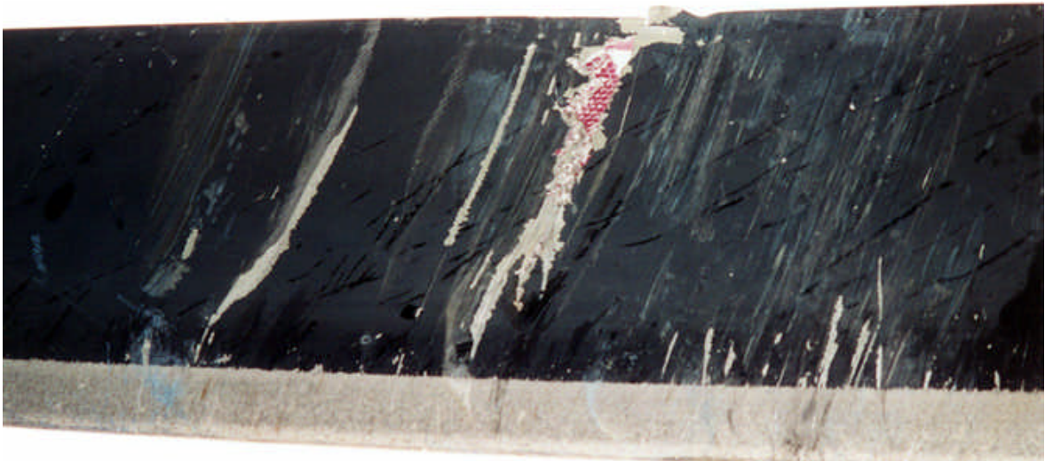
Endommagement de l'intrados d'une des deux pales du rotor principal lors du cisaillement de la poutre de queue
