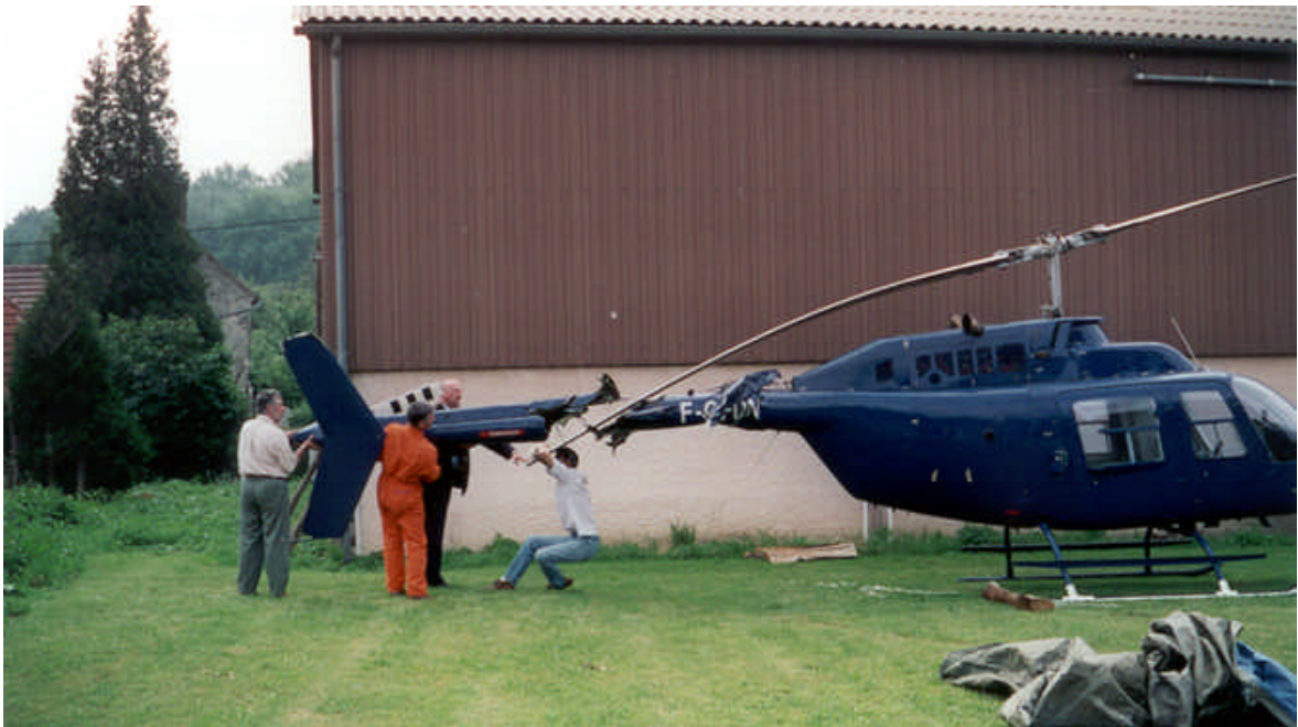
Reconstitution du processus de cisaillement de la poutre de queue par le basculement en arrière du rotor principal.
