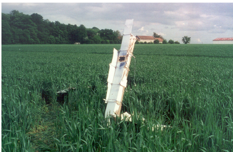
Morceau de longeron de l'aile droite
