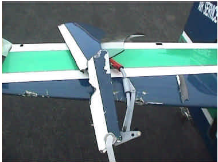
Figure 2 - Plan horizontal droit photographié au sol après l'atterrissage
