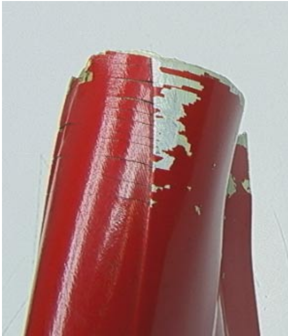
Cliché 4 : bord d'attaque – indices de traction
