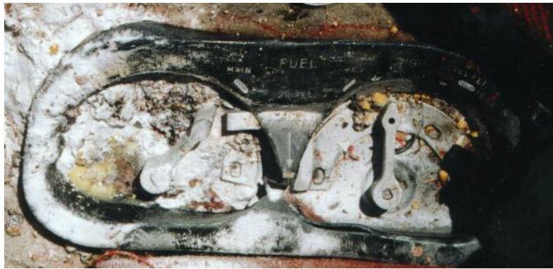
Sélecteurs carburant (à gauche sélecteur moteur gauche, à droite moteur droit)
