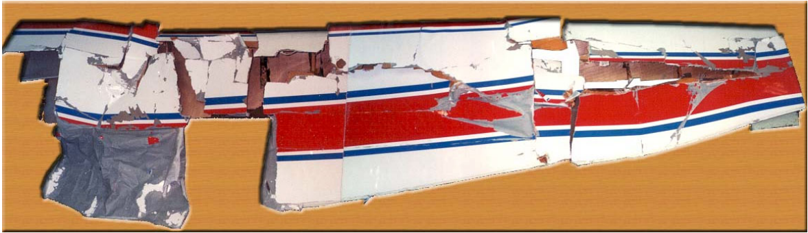
Reconstitution du revêtement de l'aile gauche - côté intrados
