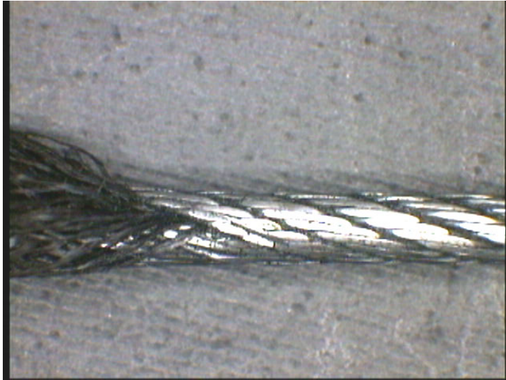
Face du câble droit usée par frottement au niveau de la rupture
