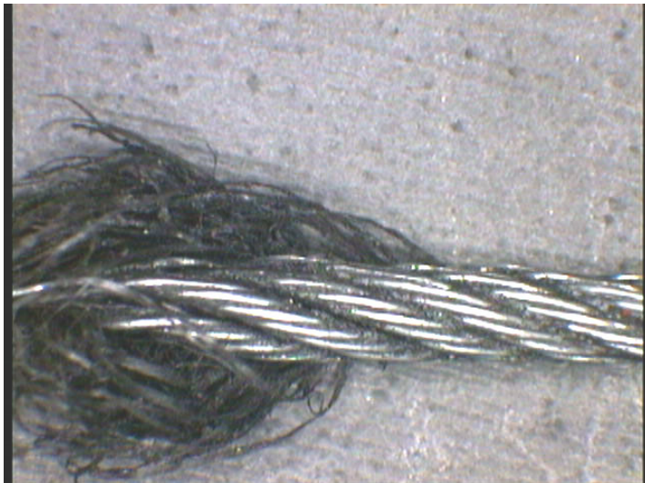
Face opposée du câble droit non usée par frottement au niveau de la rupture
