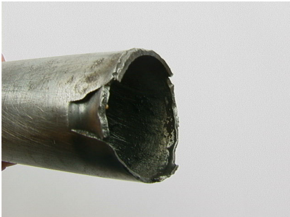
Rupture en flexion de la jambe de train avant
