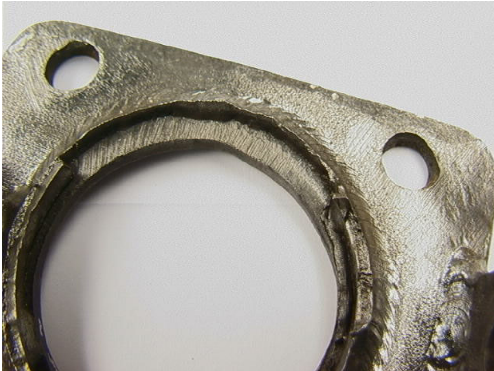
Défaut de soudure sur le support de roue avant
