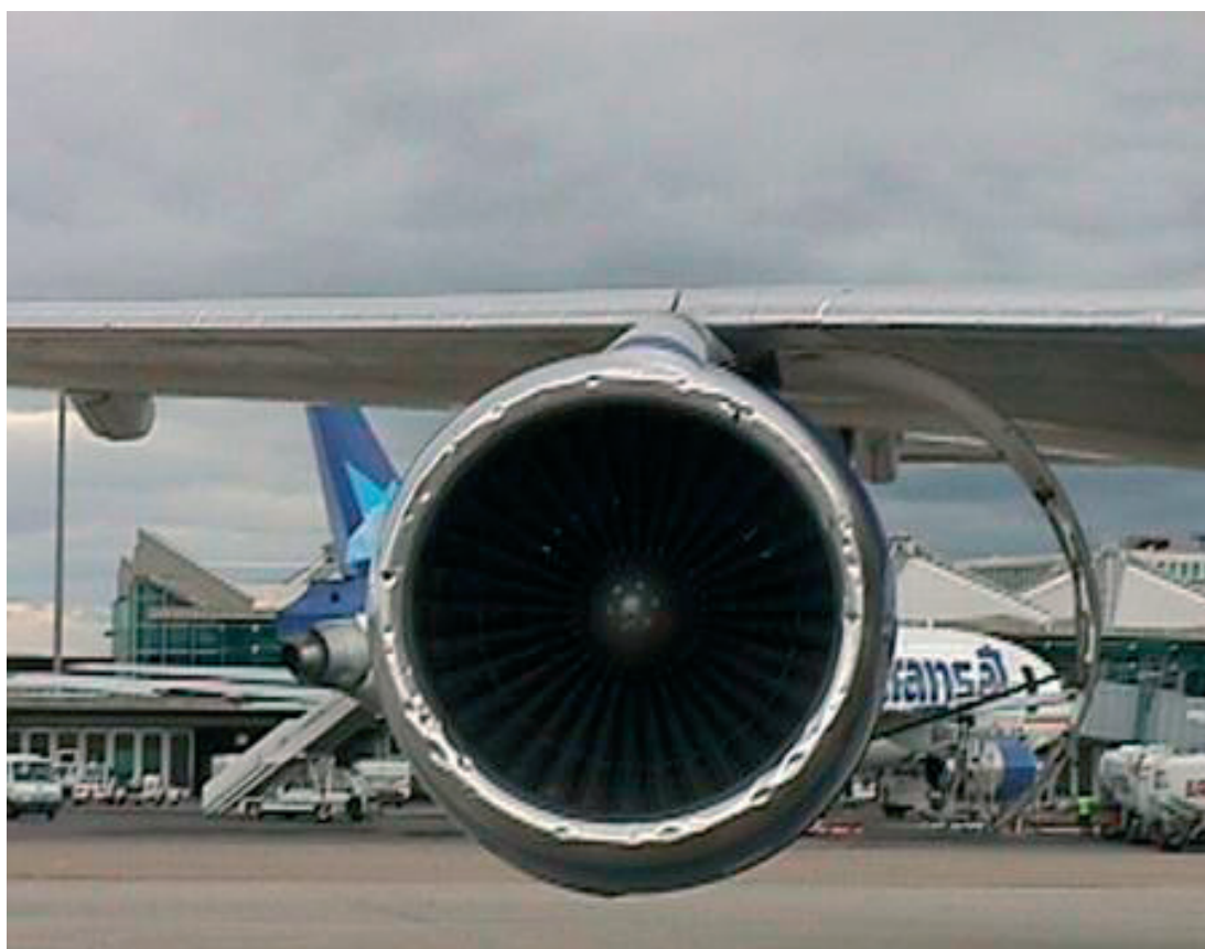
Impacts de la grêle sur le moteur droit
