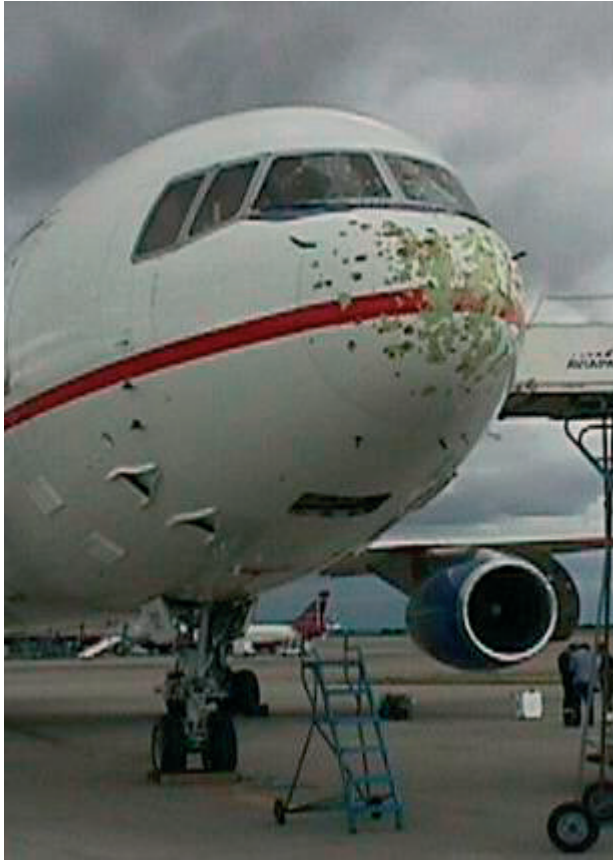
Impacts sur le nez de l'avion et le pare-brise
