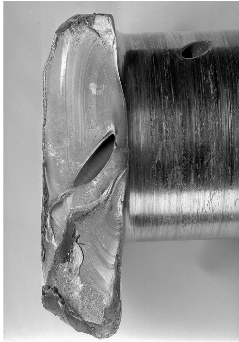
Figure 1 : Faciès de la rupture en fatigue du vilebrequin.
