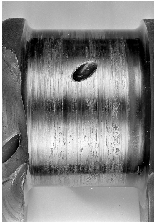
Figure 4 : Traces de frottement et rayures sur le tourillon, déportées vers le congé arrière (à gauche sur la photographie).
