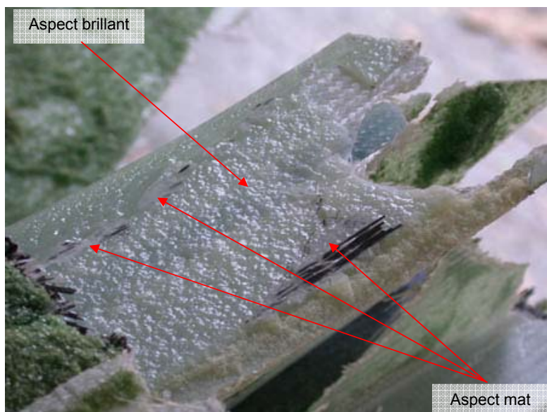
Photo 9 : interface de la liaison âme/semelle, plages mates (correspondant aux zones de collage effectif) et plages brillantes (correspondant aux surfaces non en contact avec un autre support)
