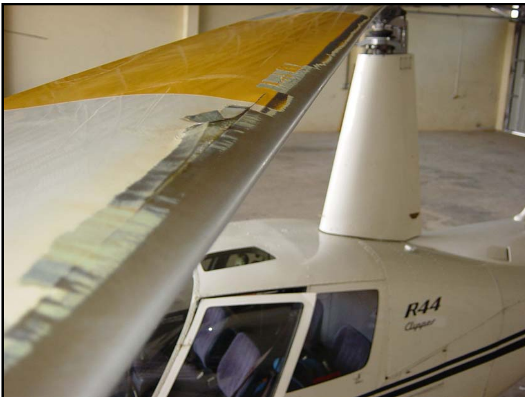
pale du rotor principal (usure du bord d'attaque et déchirure du revêtement métallique)
