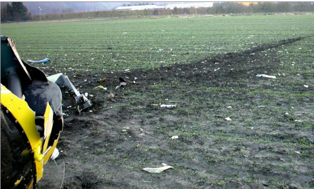
Des traces de patins de 3 à 6 m de longueur, alignées au cap 050°, sont visibles 50 mètres avant l'épave. Les traces finales sont plus profondes (10 à 20 cm) et plus longues (6 à 15 m), du côté droit.
