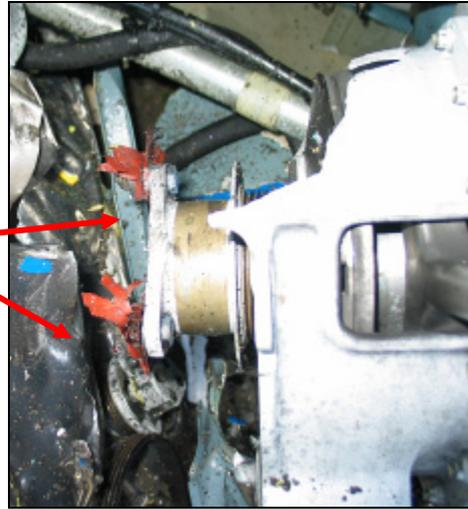
L'entrée d'air du compresseur axial présente des traces très importantes de frottement, montrant une rotation du compresseur à l'impact.
