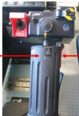
Le verrou de la butée de position vol de la poignée tournante est sur « déverrouillage ».
