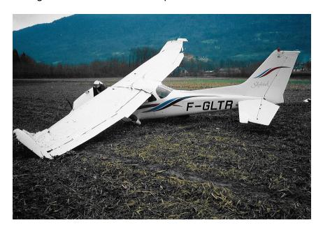
Le moteur est quasiment désolidarisé de l'avion. L'hélice est légèrement tordue et son état montre qu'elle transmettait de la puissance.
