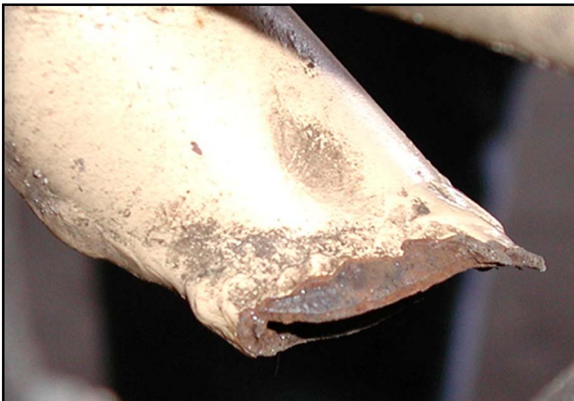
oxydation au niveau de la rupture
