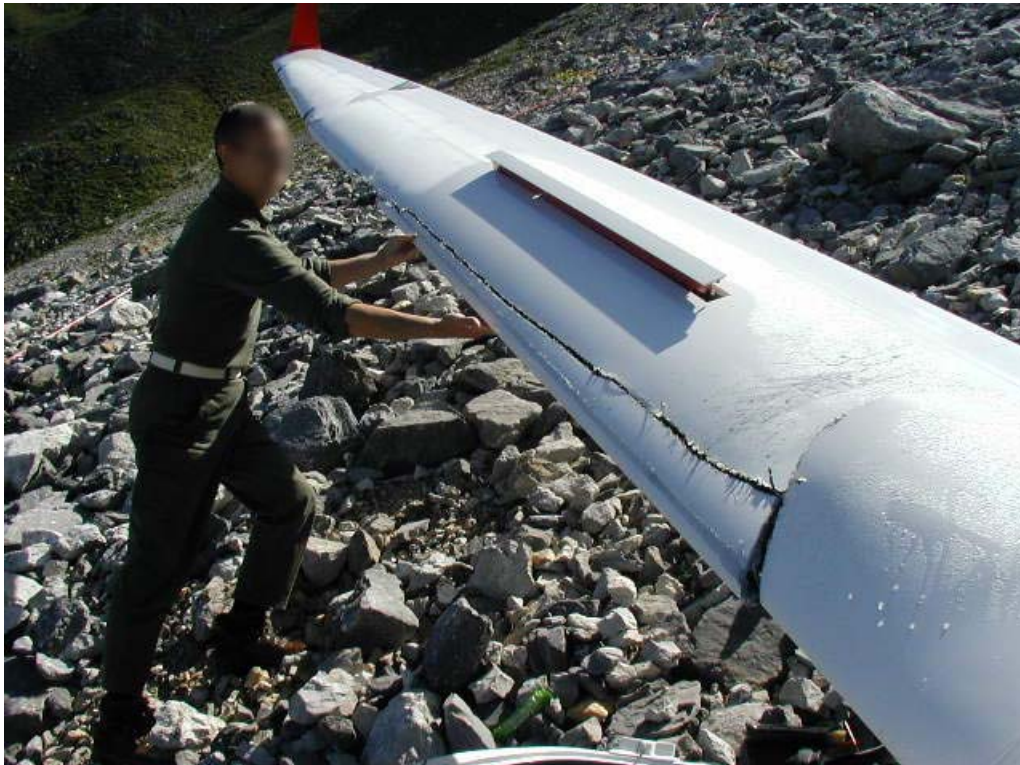
Rapprochement de la partie du bord d'attaque arrachée avec l'aile droite
