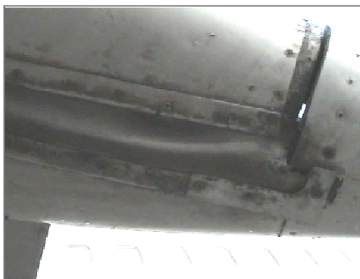
Exemple d'un carénage de rail de volet désolidarisé en l'absence de certains rivets
