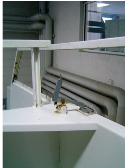
Levier de manœuvre de la joue droite, sans poignée et avec mécanisme rouillé.
