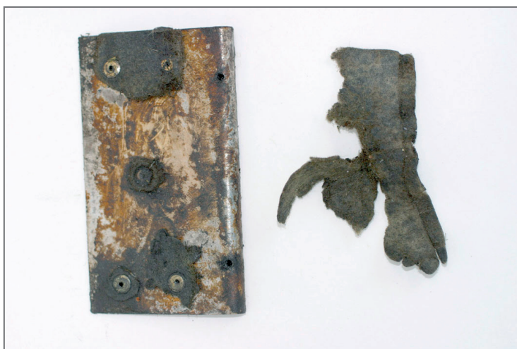
Volet de réchauffage carburateur et sa feutrine endommagée
