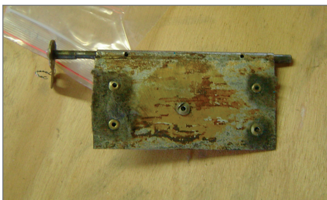
Volet de réchauffage carburateur, déposé lors d'une opération de maintenance sur un autre avion ROBIN
