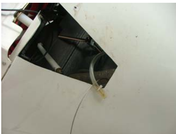
Mise à l'air libre du réservoir le long du fuselage
