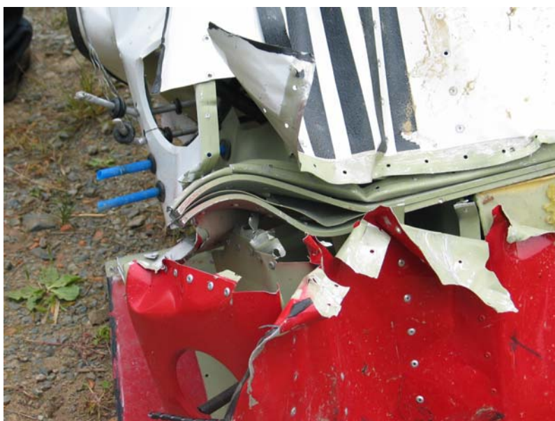
Photographie de la demi-aile gauche après démontage
