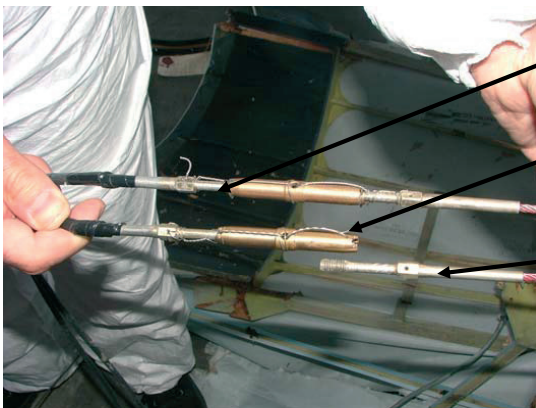
La partie arrière du câble à cabrer (câble long) est désolidarisée au droit de la jonction avec le tendeur.
