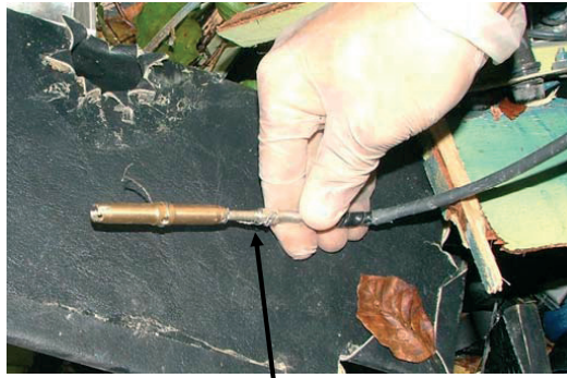
La partie avant du câble à cabrer (câble court) est restée assemblée, freinée avec le tendeur.
