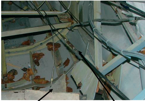
La partie arrière du câble à cabrer (câble long) est désolidarisée au droit de la jonction avec le tendeur.
