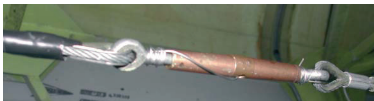
Assemblage du câble à piquer : embouts filetés différents, tendeur sans gorge et freinage réalisé par du fil-frein
