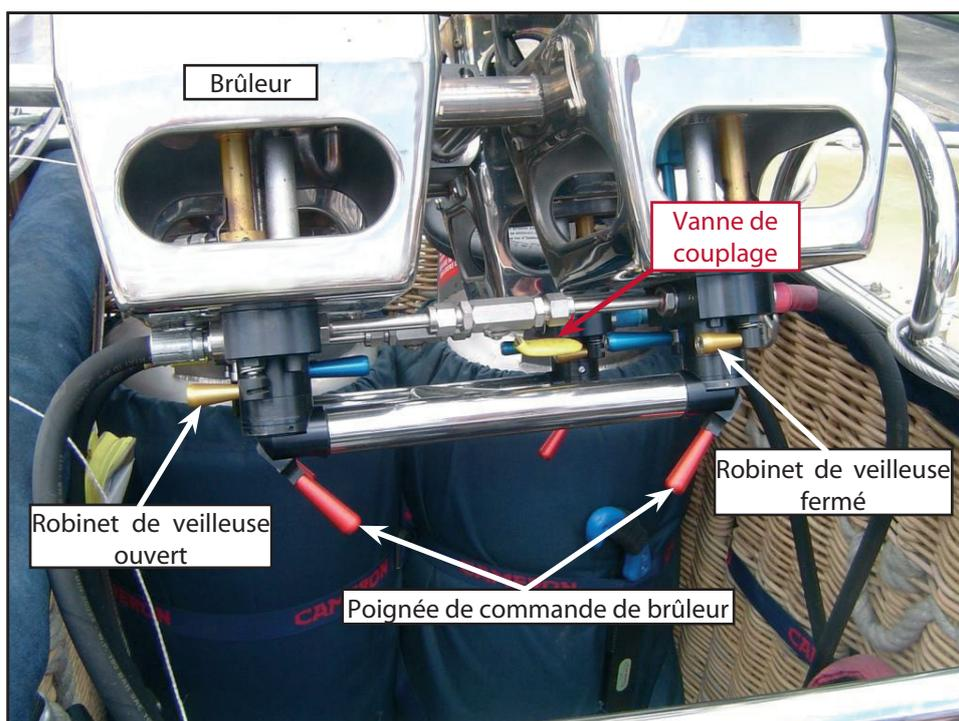
L'examen technique des quatre brûleurs et des commandes a montré qu'ils fonctionnaient correctement. Le temps d'extinction des quatre veilleuses, après coupure de leur alimentation, n'est pas identique et varie d'une à quatre secondes.
