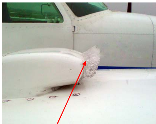
accumulation de glace sur une entrée d'air moteur
