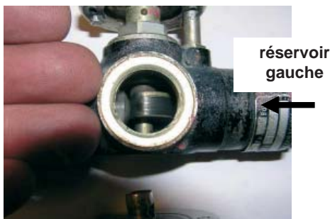
fonctionnement normal du sélecteur : réservoir droit sélectionné en cabine. La came commande la fermeture de l'arrivée du carburant du réservoir gauche.
