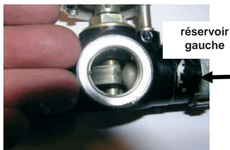
fonctionnement du sélecteur équipant le F-BVLD : réservoir droit sélectionné en cabine. La came commande la fermeture de l'arrivée du carburant du réservoir droit.
