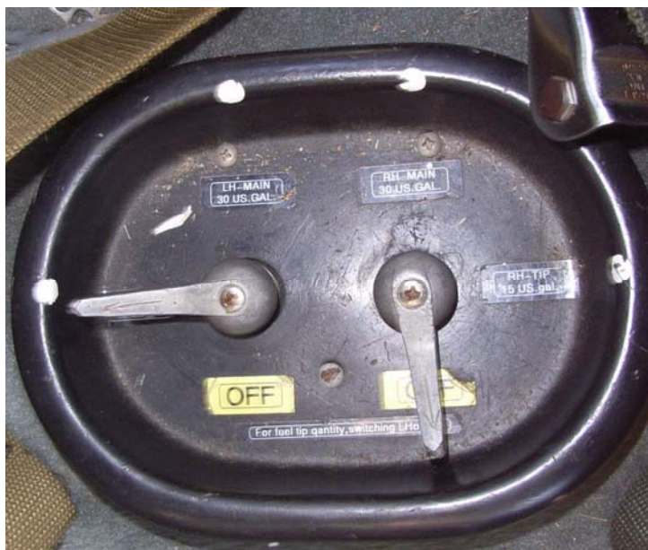
vue de la position des sélecteurs des réservoirs lors du décollage
