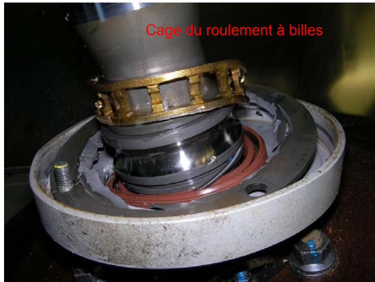
Roulement à billes situé sur la BTP, au niveau de la sortie de l'arbre de transmission du RAC
