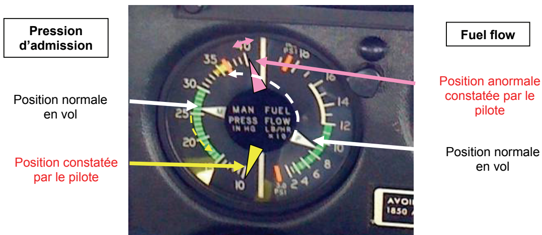
Figure 5 : indicateur double de pression d'admission et de débit carburant (Débitmètre analogique)
