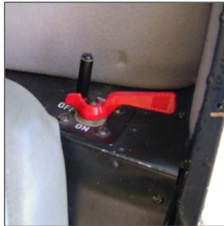
Position du robinet carburant constatée sur l'épave
