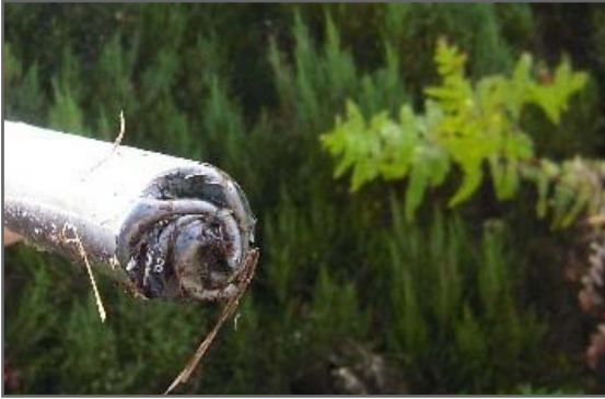
Arbre de Transmission arrière coté BTA
