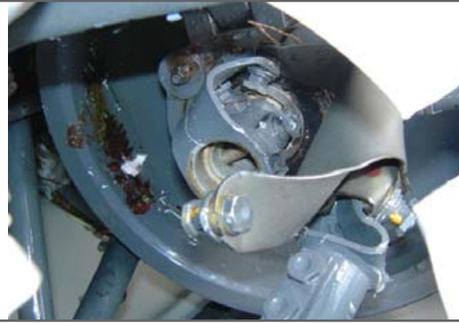
« Flex Plate » Liaison BTA-Roue libre
