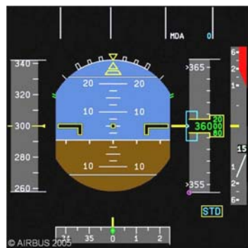
Informations TCAS sur le VSI (cas d'un avis préventif à gauche, correctif à droite)
