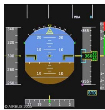
Informations TCAS sur le VSI (cas d'un avis préventif à gauche, correctif à droite)
