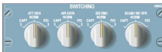
Vol de l'événement : à l'arrivée, la connexion du DMC 1 a été vérifiée. Le DMC1 et le DMC2 ont été croisés. Les essais de transferts n'ont révélé aucune anomalie.
