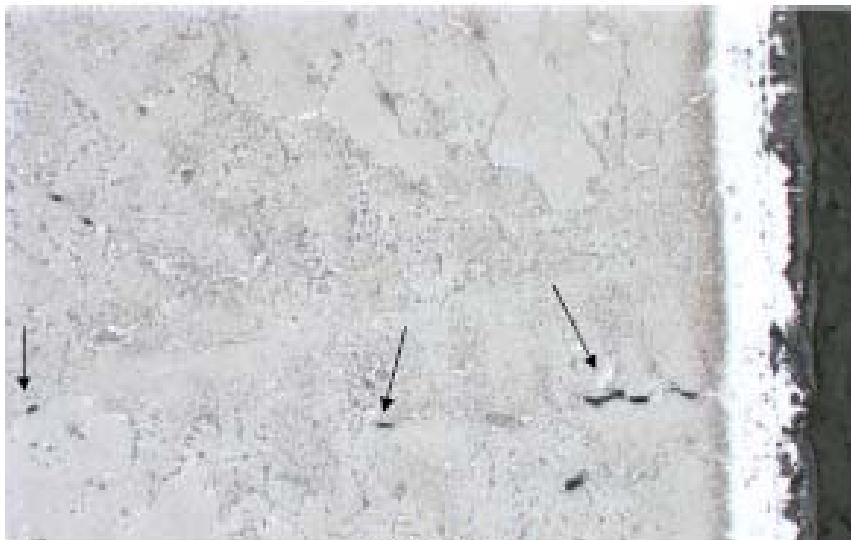
Photo n° 51 Blade N° 47 showing microvoids
