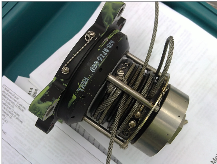
Boucle formée par la partie libre du câble ayant bloqué la servo-commande du pilote automatique
