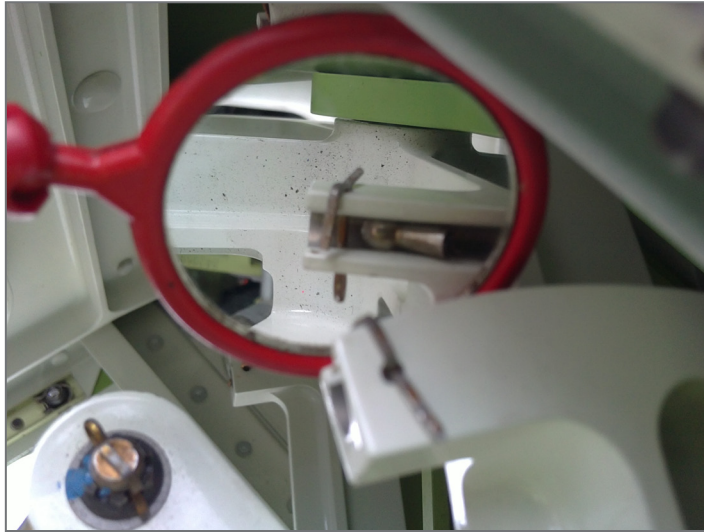
Extrémité du câble rompu, maintenue dans son logement dans le quadrant, vue au miroir
