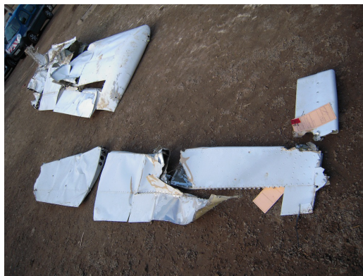
Figure 13 : gouverne de profondeur droite reconstituée
