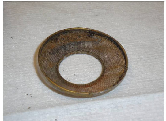
Pollution sur la crépine du répartiteur
