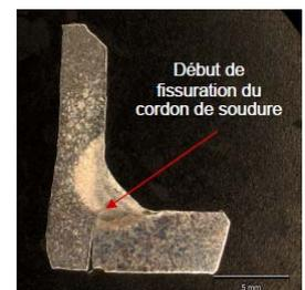
Soudure platine supérieure
