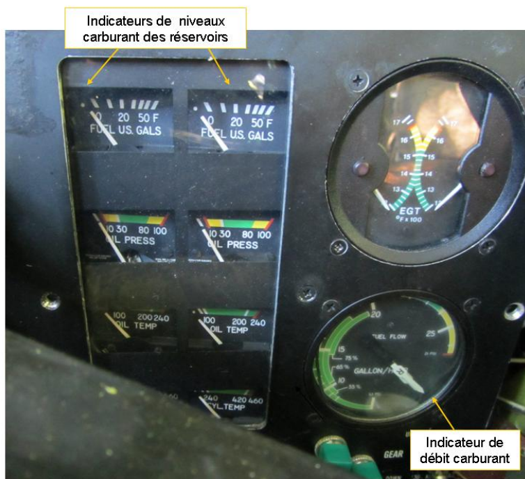
Figure 2 - photographie des indicateurs carburant du D-GABE prise après l'accident
