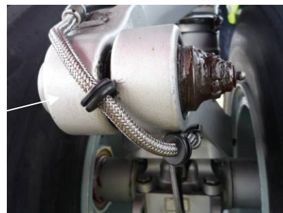
Schéma et photos (vue de profil et de face) de la liaison d'un compas de train avant d'A300-B4
