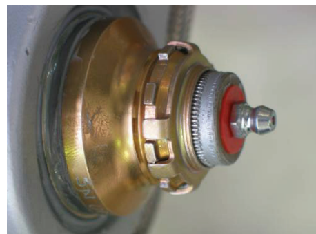
Photo de l'extrémité de l'axe avec 0,5 mm de cannelures visibles après la rondelle frein
