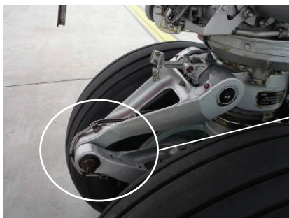
Schéma et photos (vue de profil et de face) de la liaison d'un compas de train avant d'A300-B4
