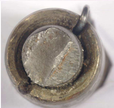
Rupture n°3 « déclarée coupée » - Lacet
