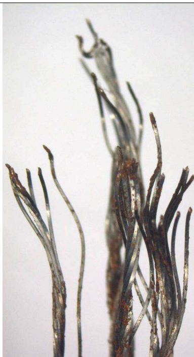
Rupture n°6 – Trim de roulis
