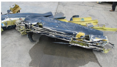
Compression du bord d'attaque de la demi-voilure gauche
