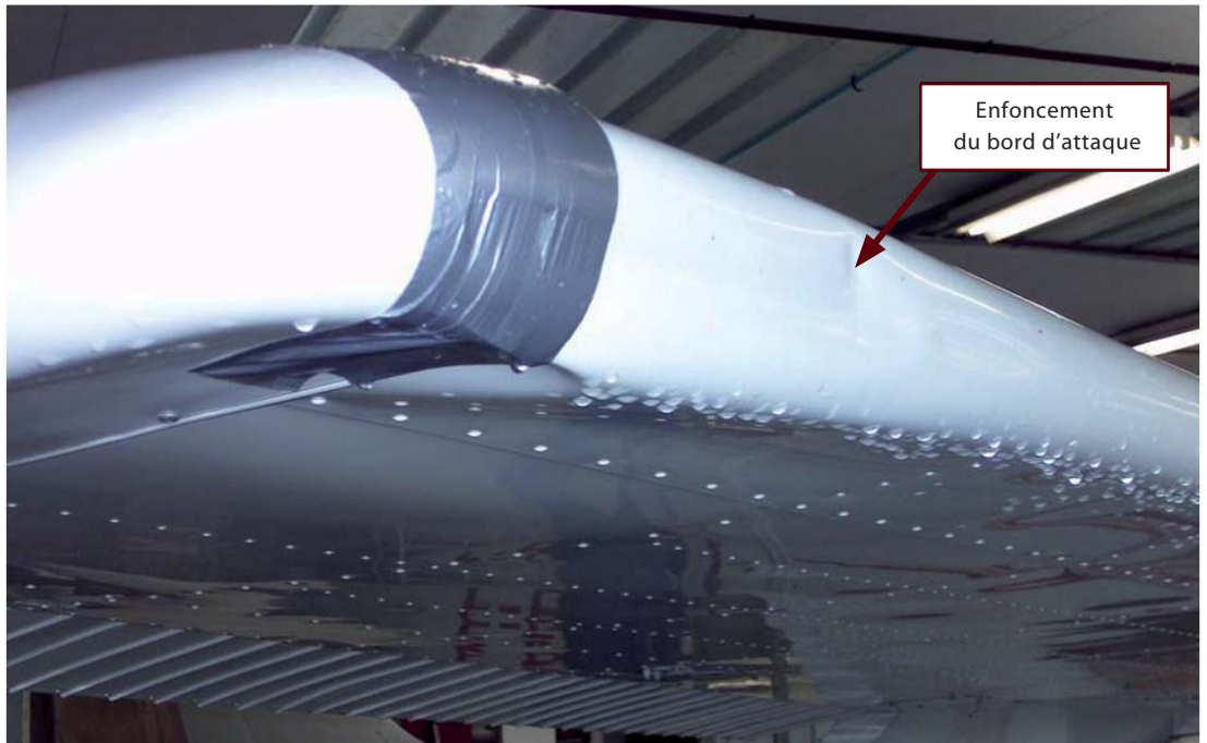
Dégâts apparents sur le bord d'attaque et le saumon
